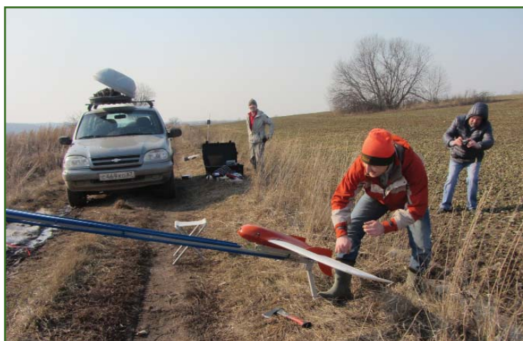
Рис. 3 Подготовка к полету АФК на основе БПЛА Геоскан 101
