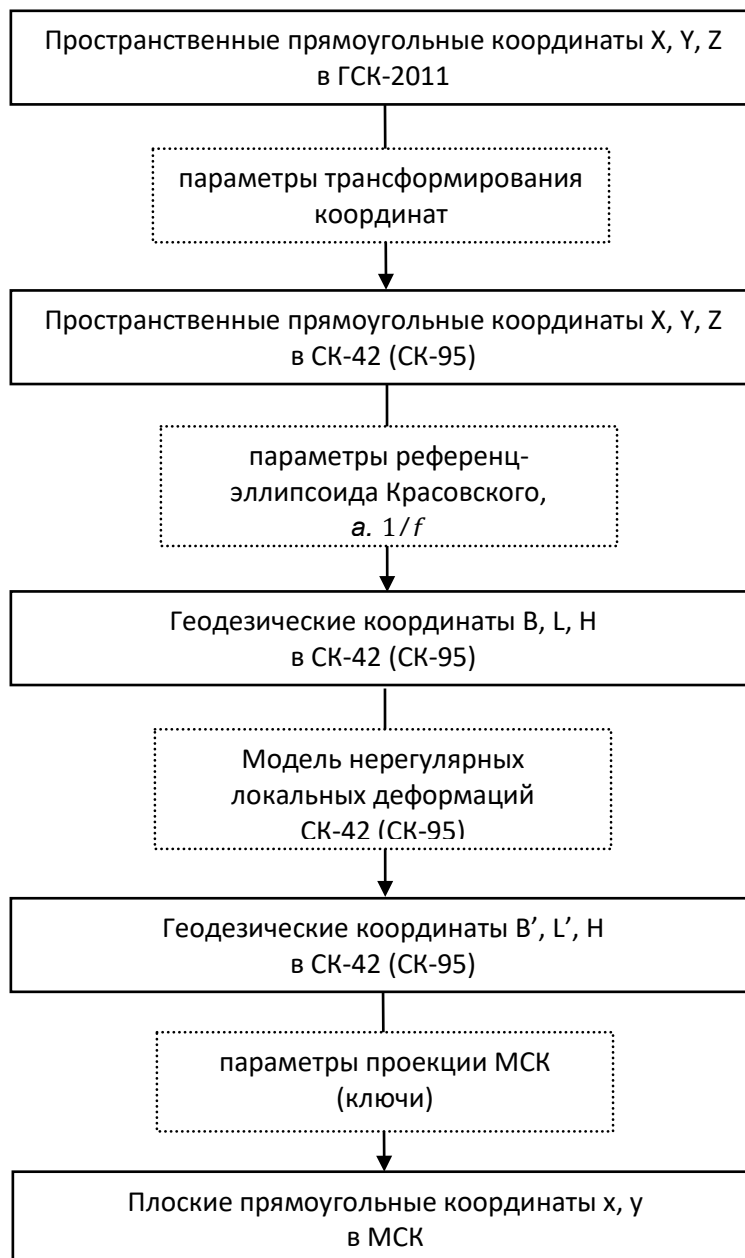
Рисунок 2 – Порядок преобразования координат из ГСК-2011 в МСК при спутниковых определениях с использованием математической модели нерегулярных локальных деформаций СК-42 (СК-95).
